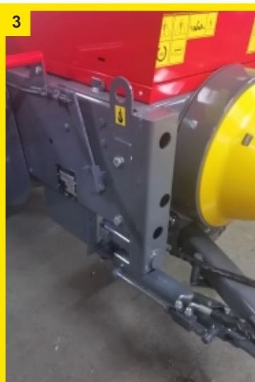
3 Sollevamento idraulico raccoglitore e spostamento idraulico timone (opzionale) Hydraulic pick-up lift and hydraulic drawbar adjustment (special equipment)
